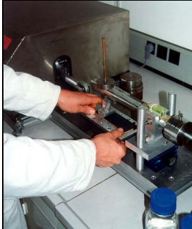
Fig. 1 : Crockmeter : Solidité aux frottements (ISO105-X12 et ISO105-D02)
