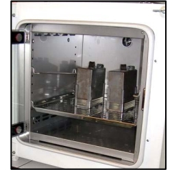
Fig. 7 : Perspiromètre : Solidité des teintures à la sueur (ISO105-E04)
