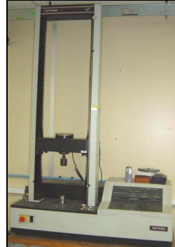
Fig. 6 : Propriété des étoffes en traction (ISO13934-1)
