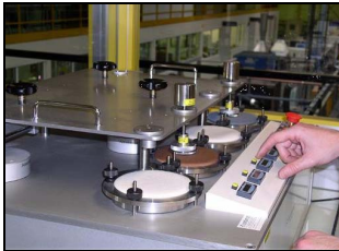
Fig. 2 : Abrasimètre Martindale : Résistance à l'abrasion des étoffes (ISO12945 et ISO12947)
