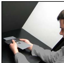
Fig. 4 : Cotation échelle des gris en cabine à lumière (ISO105-A02)
