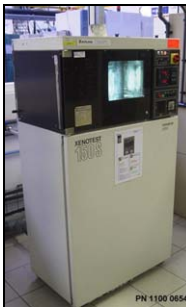
Fig. 3 : Xenotest 150S : Solidité à la lumière artificielle (ISO105-B02 et ISO105-B04)
