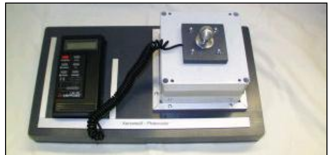
📌 Unité de mesure : Source lumineuse + Photodétecteur + Photomètre
